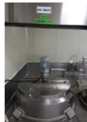
시설 | 액상혼합탱크 용량 | 1.5ton
